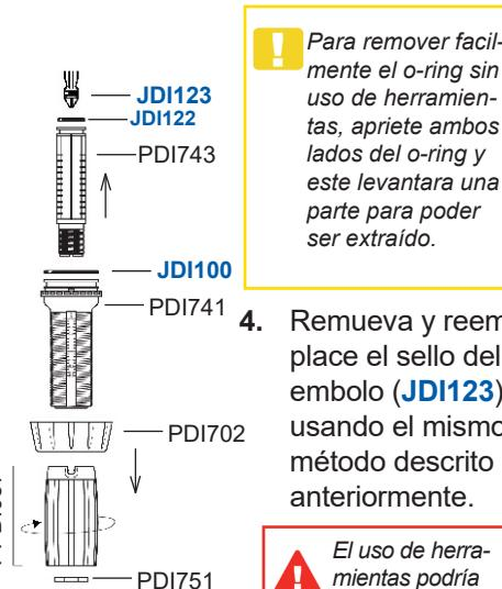
**! Para remover facilmente el o-ring sin uso de herramientas, apriete ambos lados del o-ring y este levantara una parte para poder ser extraido.**
