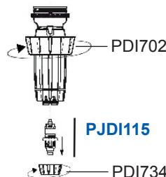
**! Recomendamos limpiar todas las partes con agua tibia jabonosa y un cepillo de dientes, antes de instalar las partes nuevas. El agua normalmente lubrica las partes, pero usted puede usar silicon en el o-ring para facilitar la inserción. La válvula cheque se puede desamar y limpiar entre mantenimientos para remover las partículas.**
