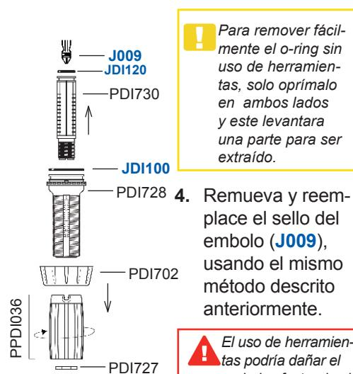
**! Para remover fácilmente el o-ring sin uso de herramientas, solo oprimalo en ambos lados y este levantara una parte para ser extraido.**
