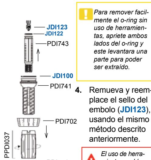
**! Para remover facilmente el o-ring sin uso de herramientas, apriete ambos lados del o-ring y este levantara una parte para poder ser extraido.**
