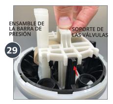
Alinee el soporte de las válvulas junto al ensamble de la barra de presión y asegúrese de que el soporte se alinea con las barras negras en la cobertura del pistón y las válvulas inferiores entran en los 4 orificios centrales.
