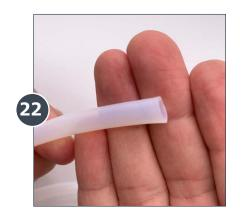
Antes de instalar la manguera de succión, inspecciónela. Si está ensanchada, córtele una pulgada más o menos y vuélvala a instalar.
