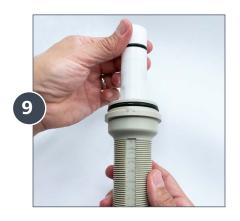
Empuje la barra de inyección blanca hacia arriba y fuera de la manga de inyección con escala de graduación.
