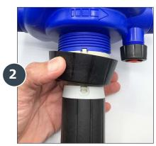
Desatornille la tuerca del ensamble de inyección.
