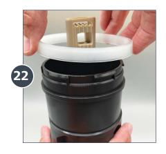
Tome el **Anillo Inferior** (**PDI1092**) del nuevo kit, y deslícelo sobre la cobertura del pistón con la abertura en forma de **V** hacia abajo y el borde plano hacia arriba.
