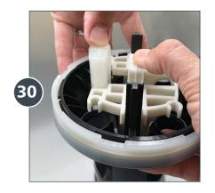
Comience a presionar con cuidado el mecanismo (ambos ensambles) en su lugar, dentro de la cobertura del pistón y vuelva a verificar la alineación de ambas secciones.
