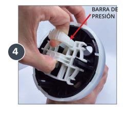
Levante la barra de presión y jale el mecanismo plástico hacia afuera del pistón.
