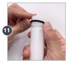
Remueva y reemplace el **O-Ring** de la Barra de Inyección (Parte #: **JDI120**).
