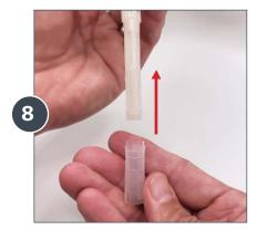
Coloque el NUEVO Sello de la Barra de Presión (PDI1085) en la barra de presión con la parte delgada apuntando hacia la barra. Cuando este en posición gírelo un cuarto de vuelta en la misma dirección de las manecillas del reloj para asegurarlo.
