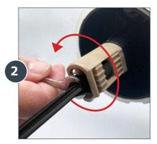
Remueva el émbolo del pistón, girándolo un cuarto de vuelta en la dirección contraria a las manecillas del reloj, utilizando una llave de 8mm.
