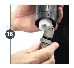
Instale la nueva **Válvula Cheque** (Parte #: **PJDI232**) dentro del ensamble de inyección.
