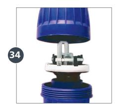
Inserte el pistón de nuevo dentro del inyector Dosatron y atornille la campana tapa del inyector.
