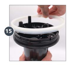
Tome el **Anillo Superior** (**PDI1093**) del nuevo kit, y deslícelo sobre la cobertura del pistón con la abertura en forma de **V** hacia abajo y el borde plano hacia arriba.
