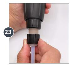
Deslice la manguera y la boquilla sobre la lengüeta en la parte inferior del Dosatron, y apriete la tuerca de la manguera.
