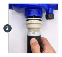
Jale el ensamble hasta removerlo de la unidad. Coloque la tuerca y el cuerpo de la unidad a un lado.
