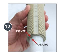
Alinee la ranura en la barra blanca con el diente dentro de la parte inferior de la manga con la escala de graduación. Empuje la barra blanca hacia abajo tanto como pueda.
