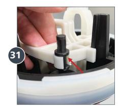
Encaje una de las válvulas superiores en el soporte de las válvulas.
