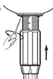
9. Desatornille los adaptadores de entrada y salida (P252). Remueve los sellos usados (J534EP) y reemplácelos con los nuevos incluidos en el kit. Atornille de nuevo los adaptadores (P252) en su lugar.
