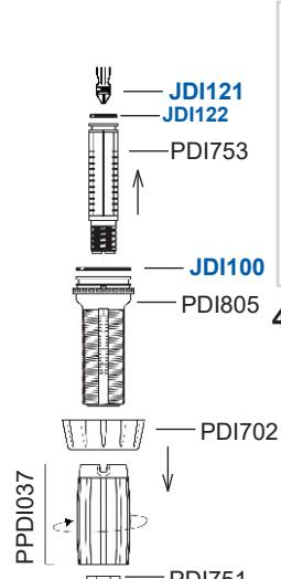
**! Para remover fácilmente el o-ring sin uso de herramientas, simplemente apriete ambos lados del o-ring y este levantara una parte para poder ser extraido.**
