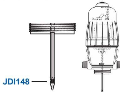
6. Sujete el vástago de inyección a la parte inferior de la unidad, asegúrese que la escala deseada se muestra en el frente del inyector. Las llaves en la parte superior de la manga negra deben encajar en las muescas en la parte inferior del cuerpo de la unidad. Atornille de nuevo la tuerca de la manga de inyección (PDI702) a la unidad.
