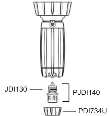
Coloque un poco de **Dosa-Lube** en el o-ring (JDI130) de la lengüeta de la válvula cheque.
