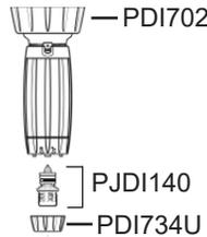
5. Coloque la parte superior de la válvula cheque (PJDI063) en la lengüeta asegurándose de insertar la porción del resorte hacia abajo. Inserte la válvula cheque (PJDI140) por la parte inferior de la barra blanca, los cuatro dientes blancos en la válvula deben encajar al lado de los dientes en la parte inferior de la barra blanca. Atornille la tuerca de la válvula cheque (PDI734U) de nuevo en su lugar.
