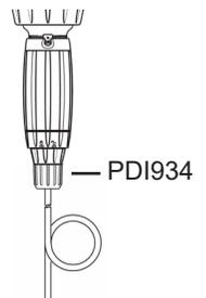
**!** Para asegurarse que haya una succión adecuada, usted puede cortar con cuidado la punta de la manguera en línea recta.
